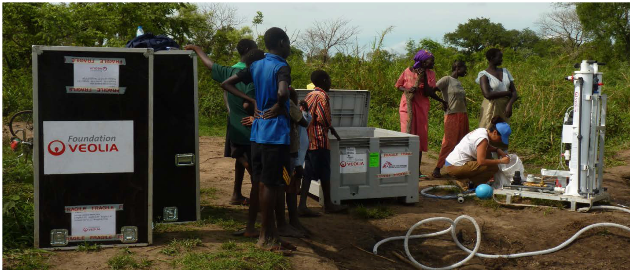
Estação de tratamento de água de urgência “Aquaforce500” testada e desenvolvida pela Fundação Veolia para a MSF no Uganda.
